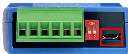
软件配置接口用来配置无法通过拨码开关配置的 CAN 波特率、CAN 口数据转发方向、CAN 屏蔽掩码过滤器。如果所用的 CAN 波特率可以通过拨码开关配置则不需要通过软件配置。配置方法见 3.1.2 软件配置波特率。
