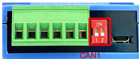
拨码开关位于 ON 的位置表示使能内部 120 欧姆电阻，拨码开关位于 OFF 的位置表示失能内部 120 欧姆电阻。
