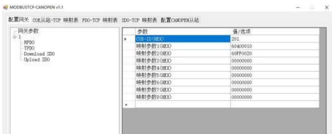
RPDO/TPDO 都需要设置 COB-ID 和映射参数。COB-ID 跟 COE 设备相关，一般在设备的说明书或 EDS 文件。映射参数在这里的作用是用来确定 PDO 数据长度和大小端转换用的。如果说明书或 EDS 文件有准确的映射参数就填写实际映射参数，如果说明书或 EDS 没有映射参数（一般不会没有）就根据 PDO 的数据部分字节长度填写，填写规则如下：
