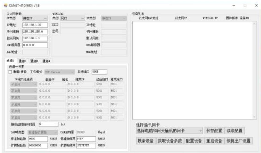
软件有五个按钮分别是“搜索设备”、“获取设备参数”、“配置设备”、“重启设备”、“恢复出厂设置”。
