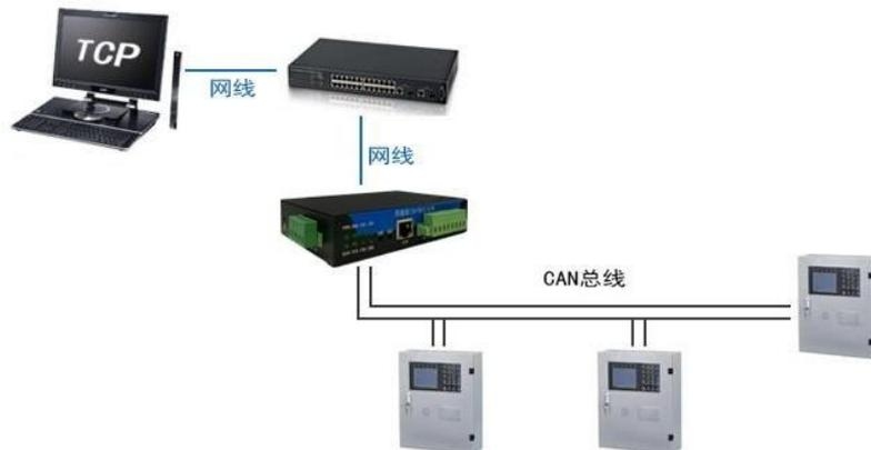
用户可以根据数据格式开发软件和Canet-410 进行网络通信，用来在电脑端控制 CAN 设备。
