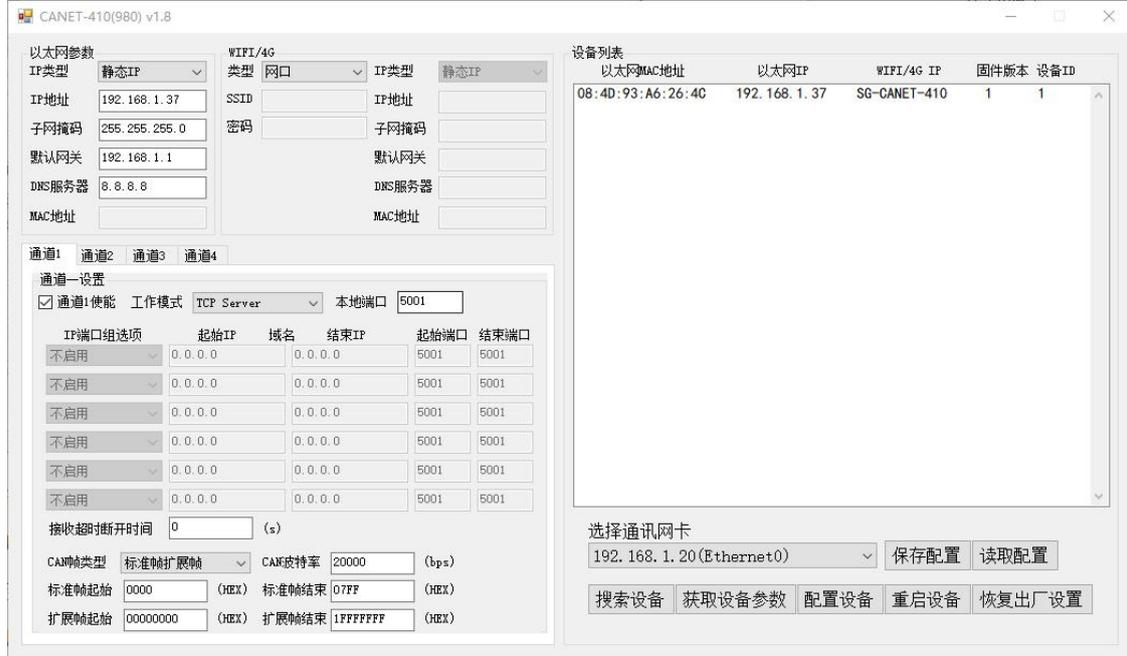
电脑上打开 CAN 分析仪设置为 20K 波特率, 同时打开两个网络调试助手。两个网络调试助手设为 TCP 客户端, 目标 IP 和端口设为设备的本地 IP 和端口, 点击连接。之后使用 CAN 分析仪发送一帧 CAN, 在两个网络调试助手可以收到 13 个字节。使用两个网络调试助手分别发 “08 00 00 00 00 00 01 02 03 04 05 06 07” CAN 分析仪会接收到两帧如下图:
