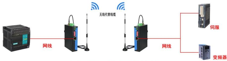
PLC和变频器/伺服之间的无线桥接示例
