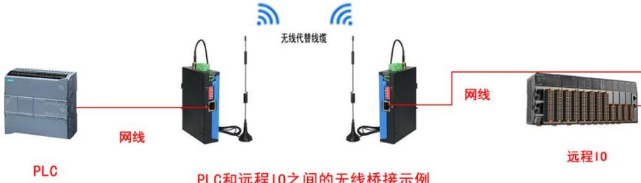
PLC和远程IO之间的无线桥接示例
